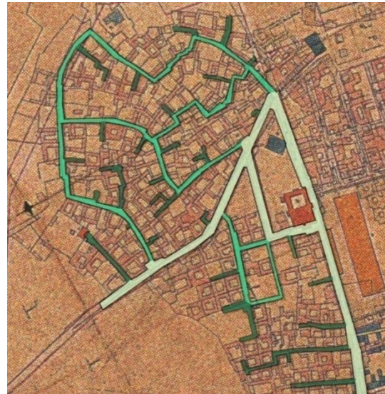
Voie corridor principale (Triq) Voie de desserte secondaire (Derb) Voie d'accès tertiaire (Driyeb)
