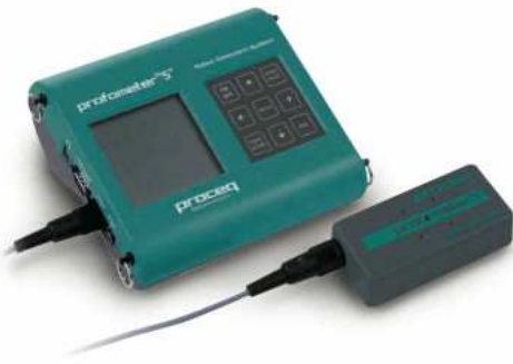
Fig. 3. Pahometru tip PROCEQ PROFOMETER 5+ (a) cu sonda de palpate pentru determinarea diametrului și poziției armăturilor (b)
