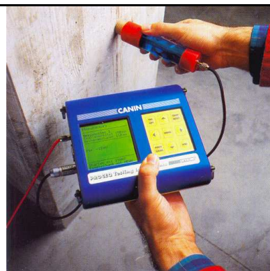
Fig. 6. Schema de determinare a coroziunii prin măsurarea rezistivității, în care: 1- microprocesor ; 2- dispozitiv pentru măsurarea potențialului de electrod a armăturilor de oțel; 3- element de beton; 4- armatură de oțel.
