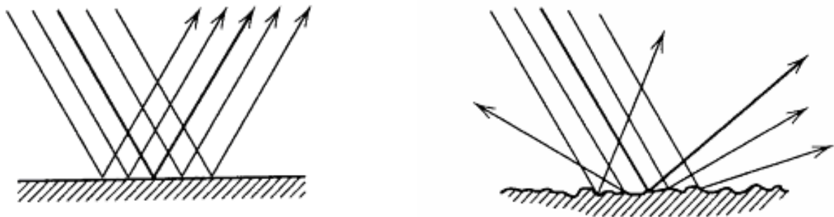
Fig. 8. Reflexia luminii pe o suprafață plană și pe o suprafață cu asperități
