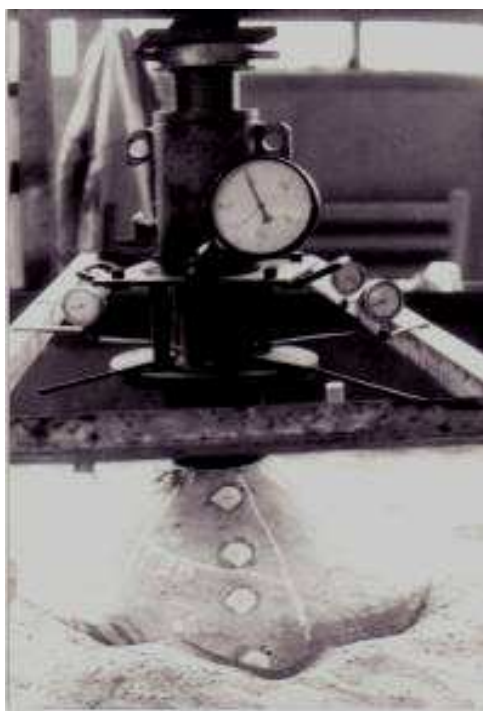
Fig. 5. Schemă element E 1 - Fundație din placă tronconică cu bloc de rezemare
