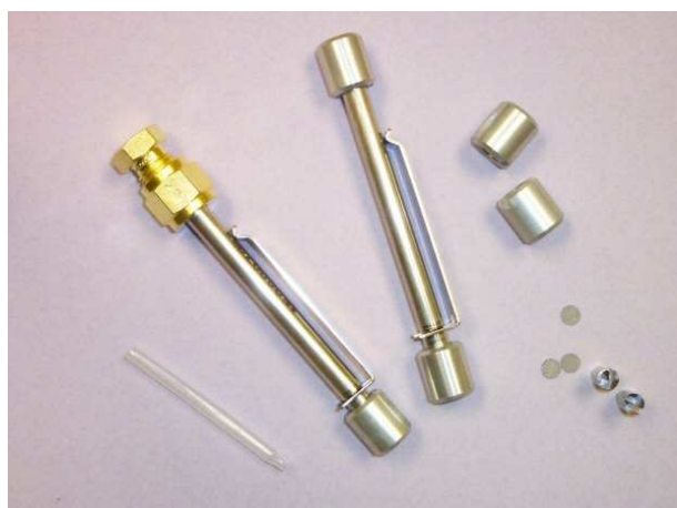
Fig. 3. Alcătuirăa unui tub adsorbant precum și tuburi adsorbante și accesorii
