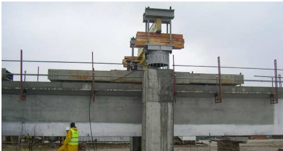
Fig. 7. Standul de încercări cu grinda U 37, detaliu
