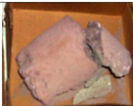
Fig. 2b. Carote de extracție sfărâmate în timpul forării, susceptibile de manipulare dificilă și de pierderi de masă în timpul cântărilor succesive
