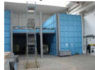
Fig. 7-8. Camera climatică Ob. 101 reconfigurată conform proiect CEEEX și spațiul hali de pregătire probe cu pod rulant 12,5 tf.
