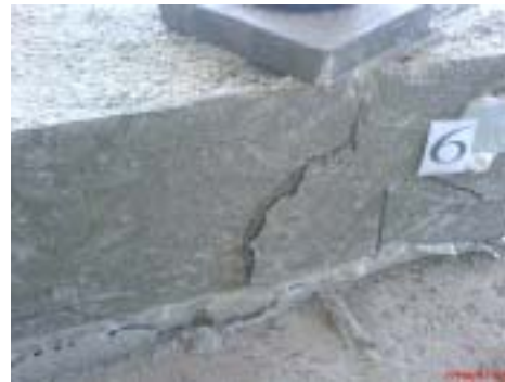
Fig. 15. Cedarea prin depășirea capacității de întindere a elementului de bordare
