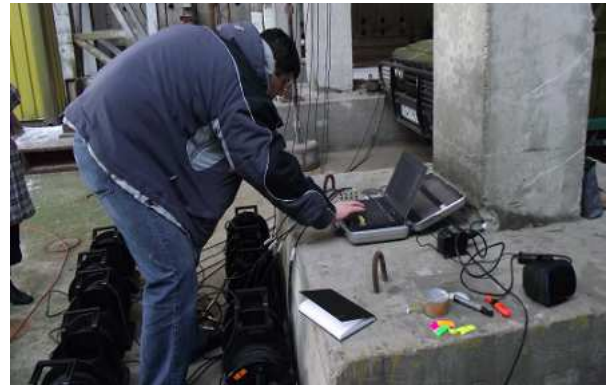
Fig. 3.2. Stația seismică cu 12 canale model GEODAS 12-USB, Buttan Service, Japonia
