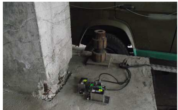
Fig. 3.3. Amplasarea unui senzor triaxial pe modelul experimental la scară naturală
